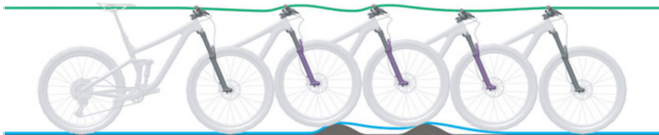
Obr. 220: Příliš pomalé roztahování odpružené vidlice
