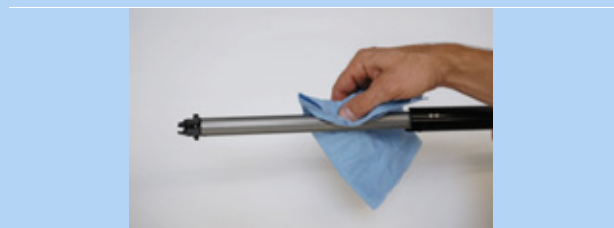
Obr. 209: Očištění podélné vodicí drážky
