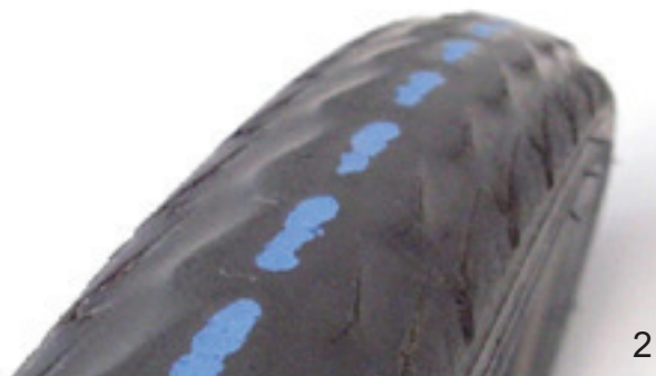
Obr. 143: Pneumatika bez běhounu, na které lze ještě jezdit (1), a pneumatika s proraženou ochranou (2), kterou je třeba vyměnit
