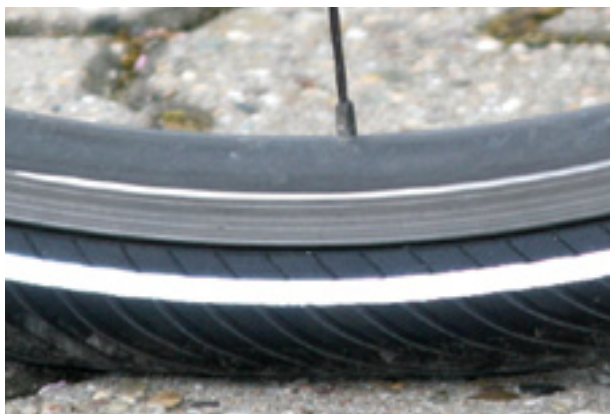
Obr. 100: Správný tlak. Pláště se působením hmotnosti těla téměř nezdeformují
